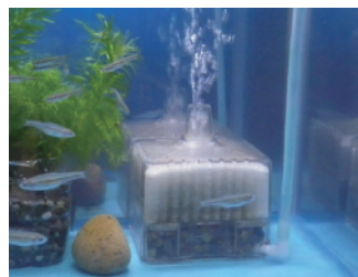
ろ過装置 (ろ過材を除く)
